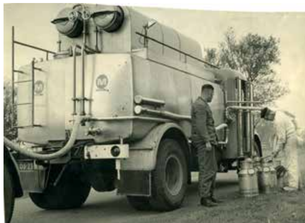
Mechanisering in melktransport. Bij de rijdende melkontvangst, ontwikkeld door N.V. Volma te Gorredijk, wordt melk uit de melkbussen gezogen, 1963. (Foto Fries Landbouwblad, Tresoar)
